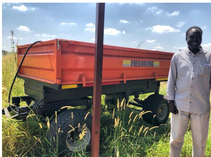
Le benne-remorque (ci-contre, avec Betram) est moderne, hydraulique et moins chère qu'un camion à benne. Elle sert au transport de toutes sortes dans la ferme. On la monte sur le vieux tracteur.
